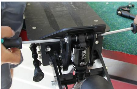
1. Lösen Sie die Inbusschrauben mit einem 5er Inbusschlüssel
