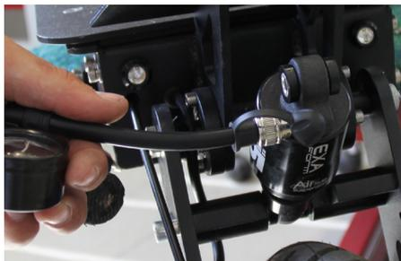
2. Drücken Sie den Stossdämpfer etwas nach vorne, um die Luft besser in den Einfüllstutzen zu pumpen. Nicht mehr als 150 psi oder 10 bar.
