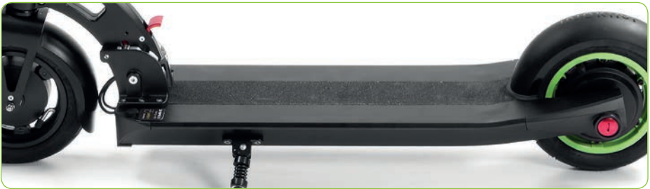
Aluminiumtrittbrett mit Antirutschbeschichtung
